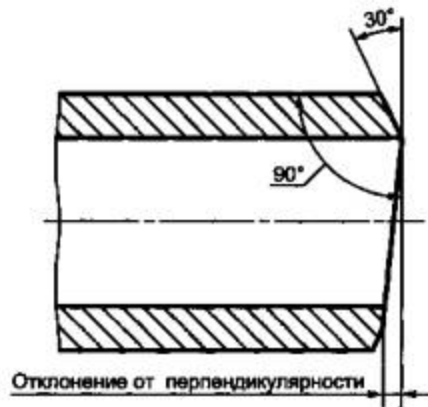
Рисунок 1 - Отклонение от перпендикулярности торца (косина реза)
